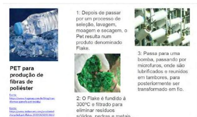
**Fig. 7** Processo de transformação de PET para produção de fibras de poliéster.
